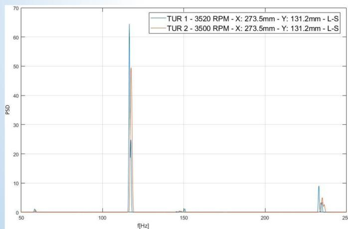
Para determinar la influencia de la intensidad de turbulencia se muestra la densidad espectral de potencia (PSD) en el caso donde la velocidad de la corriente libre es de 5m/s, para 20° de deflexión del flap, la posición P1 y la hélice de dos palas.
