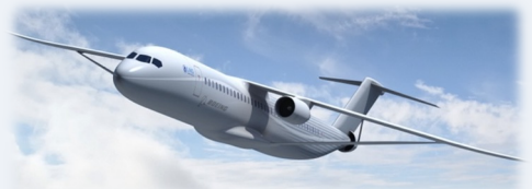
Boeing SUGAR: Prototipo de aeronave con sistema híbrido en paralelo para el transporte de pasajeros. USA. Entrada en servicio prevista: 2030-2040.
