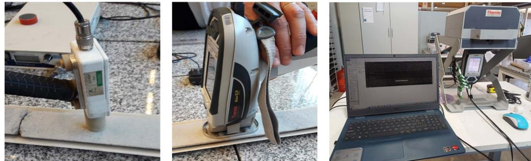
Fig. 4. Ensayos de disparo remoto.
