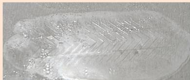
Un ejemplo de fotolitografía: resultado de una máscara puesta sobre resina dopada con nanopartículas y expuesta a luz láser UV.
