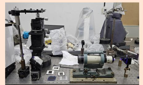
Configuración del sistema de fotolitografía UV. Los componentes principales son: un diodo láser UV (405 nm, 100 mW); un expansor de haz de alta energía (con pinhole de 15 µm); un espejo de primera superficie; una lente Nikon con un adaptador de enfoque manual (Bellows PB 4) y un soporte ajustable para portaobjetos.
