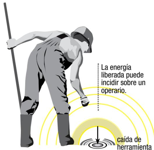
El director del LEME, el ingeniero Ricardo Dias, explicó que siempre que se produce un arco eléctrico en una instalación es por la falla de algún equipo o por contactos accidentales (por ejemplo, debido a la caída de
