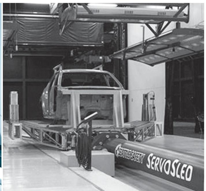
Izq: Daniel Latorraca, integrante del equipo de trabajo de la UIDET GEMA realizando un ensayo dinámico de anclaje de asientos
