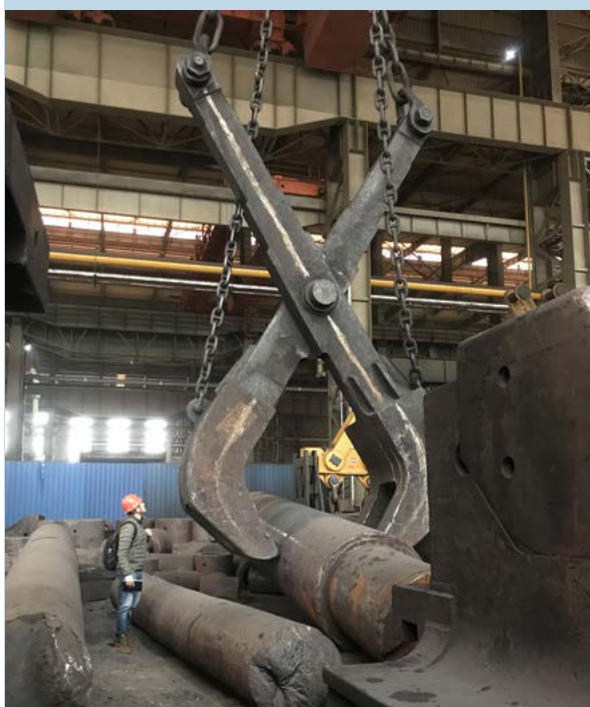
Izq: Ezequiel Carretero en la fábrica CITIC, en China, viendo un forjado de Eje de turbina.
