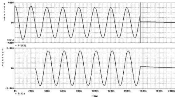
Fig. 9. Formas de onda resultantes de la simulación para la operación de establecimiento de la corriente de cortocircuito en el instante en que se produce el valor máximo de la tensión – Resistencias de regulación colocadas en el lado de baja tensión del transformador de ensayo.
