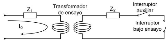
Fig. 1. Circuito de ensayo típico.
