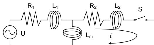
Fig. 6. Modelo de circuito simplificado.
