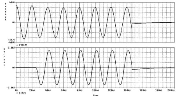
Fig. 10. Formas de onda resultantes de la simulación para la operación de establecimiento de la corriente de cortocircuito en el instante en que la tensión asume el valor nulo – Resistencias de regulación colocadas en el lado de baja tensión del transformador de ensayo.
