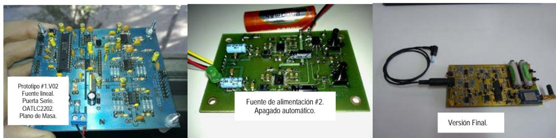
Figura 3. Distintas versiones de los prototipos implementados.
