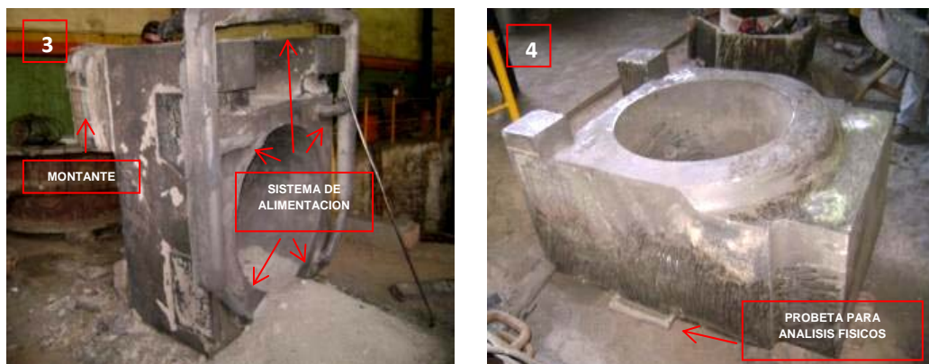
FIGURA 3 - PIEZA DESMOLDADA CON LOS SISTEMAS DE ALIMENTACION Y MONTANTES. (PESO DEL CONJUNTO 8Tn). FIGURA 4 - PIEZA REBABADA
