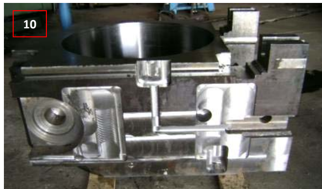
FIGURA 10 - DETALLE DEL MECANIZADO DEL ALOJAMIENTO DEL CIRCUITO HIDRAULICO EN UNA DE LAS CAJAS PORTA COJINETES
