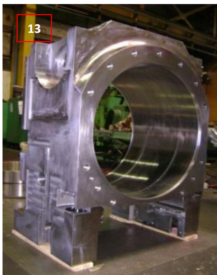
FIGURAS 13 Y 14 - CAJAS PORTA COJINETES EN SUS DIMENSIONES FINALES
