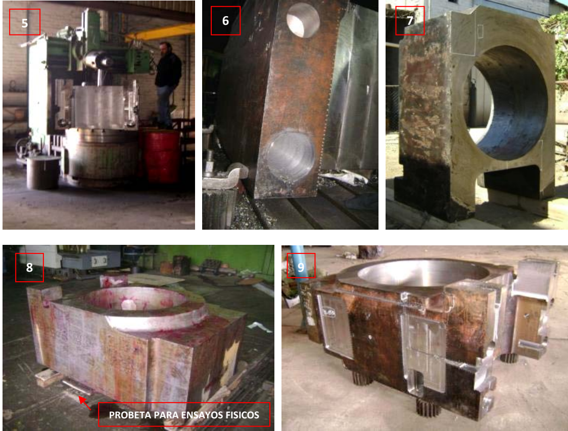
FIGURAS 6 A 9 - MECANIZADO GRUESO O DESBASTE DE LAS CAJAS PORTA COJINETES
